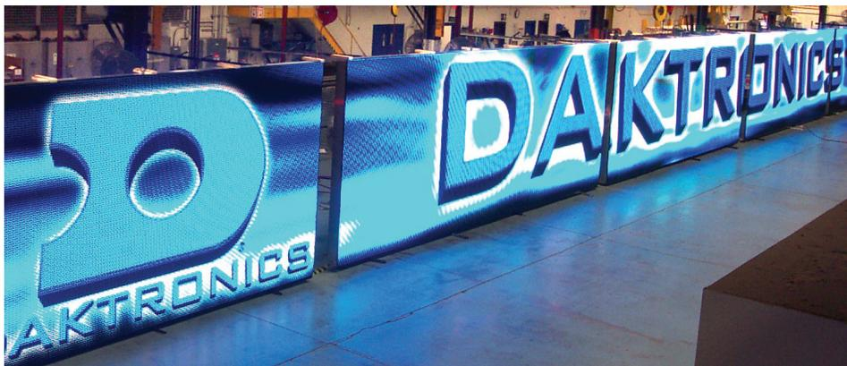
Daktronics полностью калибрует каждый модуль в дисплее перед тем как он покидает фабрику, обеспечивая тем самым дисплей с равномерным изображением.
